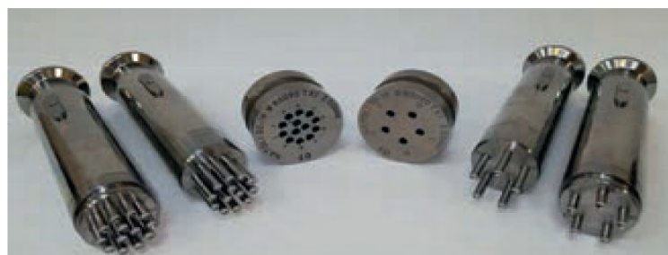
Rysunek 3. Stemple wielokrotne stosowane do produkcji minitabletek. Po lewej stronie przedstawiono narzędzia 13-krotne, po prawej stronie narzędzia 5-krotne. Zdjęcie pochodzi z pracy magisterskiej Pani mgr Magdaleny Olejniczak [18].
