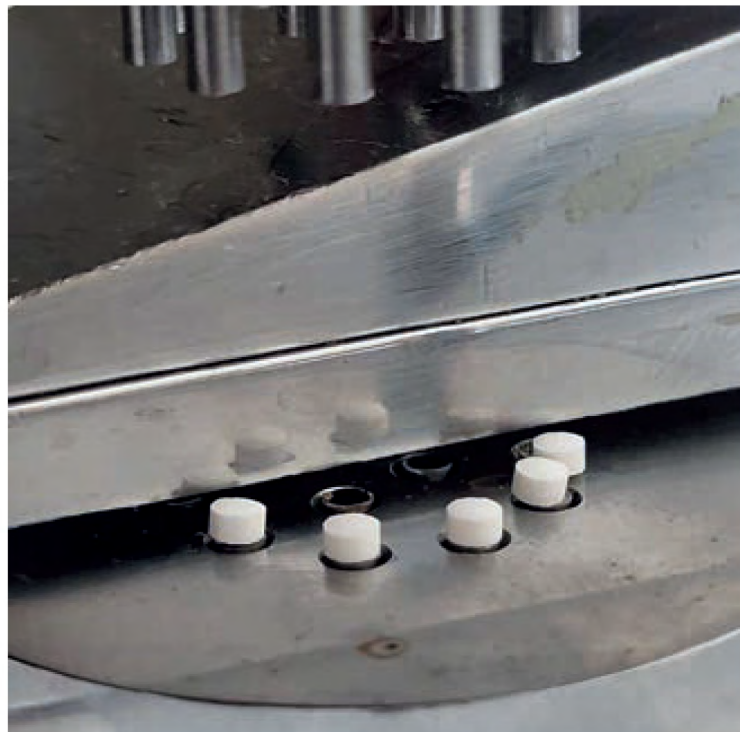
Rysunek 4. Szczelina pomiędzy górną powierzchnią matrycy wielokrotnej a krzywką zgarniającą. Na przedstawionej fotografii krzywkę ustawiono na wysokość 2 mm.
