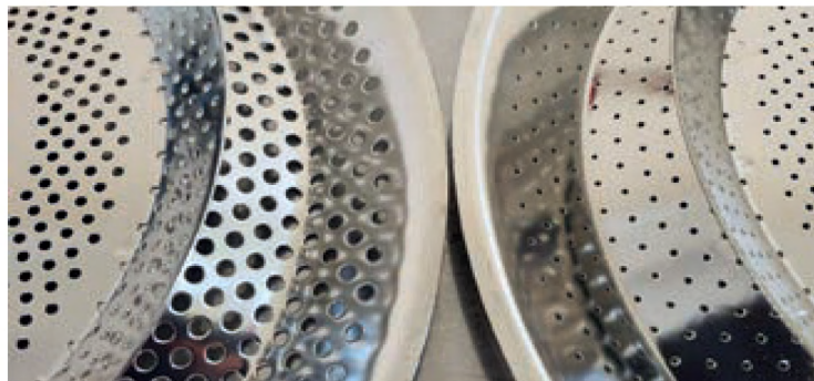
Rysunek 5. Porównanie średnicy otworów w elementach odpylacza. Standardowy perforowany talerz (po lewej stronie) umieszczono obok elementu dostosowanego do odpylania minitabletek o średnicy 2 mm (po prawej stronie).
